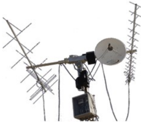
Figura 31 – Distribuição das antenas da Estação Terrena de Comunicação desenvolvidas pela empresa ISIS. Fonte: http://www.cubesatshop.com .
